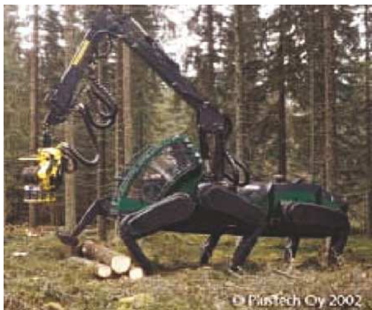
Σχήμα 7. Αυτόνομο βαδίζον όχημα για κοπή κορμών δένδρων
