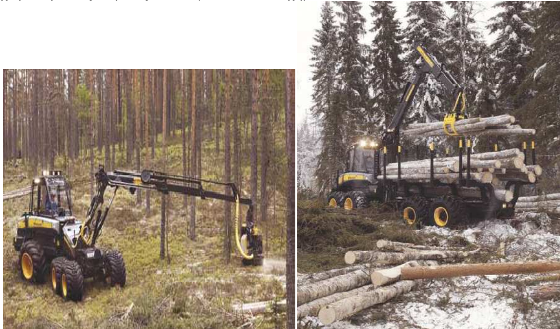
Σχήμα 6. Οχήματα για κοπή δένδρων και για μεταφορά κορμών (Halme, 1994)
